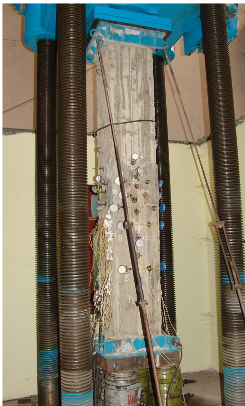
Рис. 4. Общий вид испытания образца колонны со стыком
